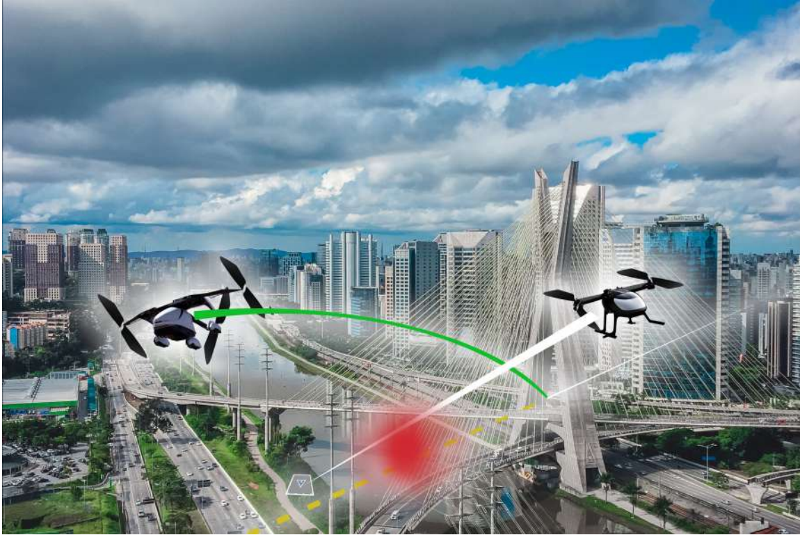
Figura 1.3: Ilustração do ISUAM em ação. A aeronave que decola do canto direito na imagem detecta o conflito e altera sua rota para evitar o intruso que decolou do vertiporto próximo ao rio.
