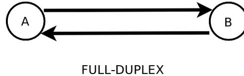
Figura 3.3: Exemplo de comunicação do tipo *full-duplex*.
